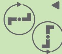
Aufbau des Mähdecks mit nicht synchron-laufenden Messern
