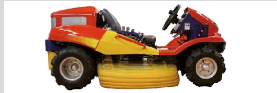
Schnitthöhen von 0 bis 150 mm (21-stufig) einstellbar
