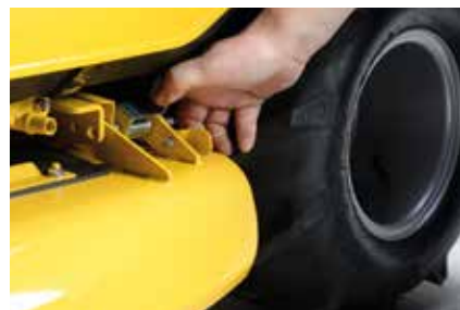
Schnellverschluss zum Abklappen der Mähwerksflügel
