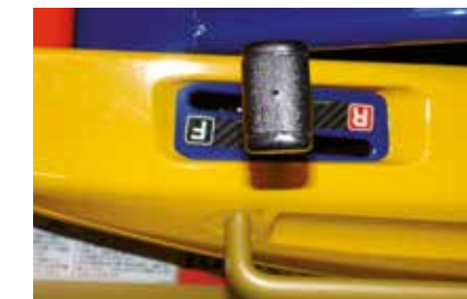
Tempomat mit Geschwindigkeitsregelung, wahlweise über Handhebel und Fußpedal
